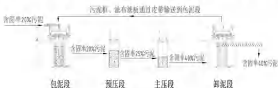
图 3.7 直压污泥脱水技术原理图
