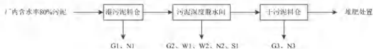
图 3.8 污泥处理工艺流程及产污环节图
