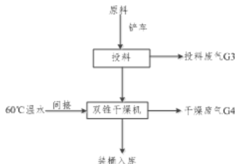
图 3.11 对溴氯苯产品生产工艺流程及产污环节图
