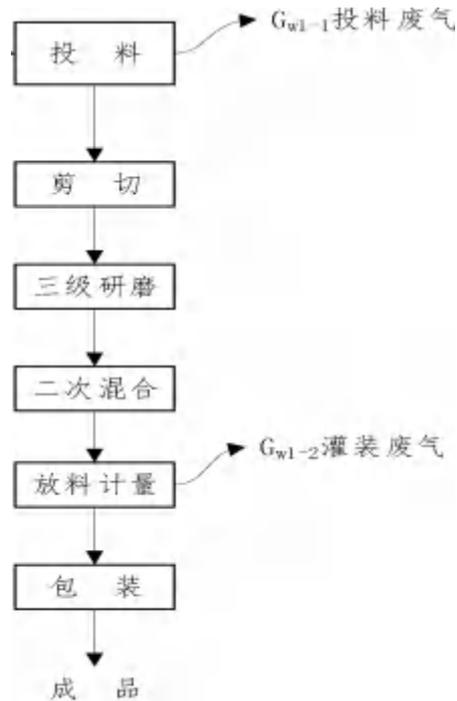
图3.18 制剂项目工艺流程及产污环节图
