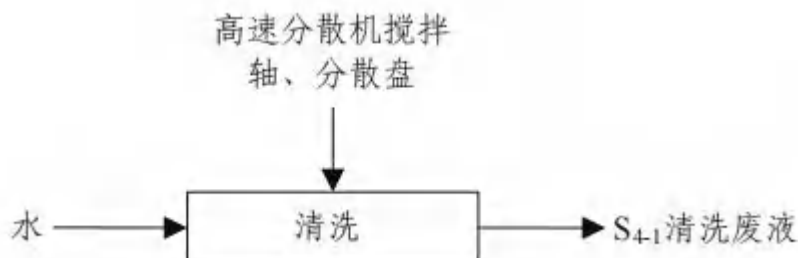
图 3.8 高速分散机清洗工艺流程及产污环节图
